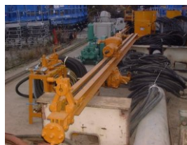
法面削孔機（吊り下げ式）
