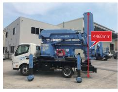
車体に干渉しないようデッキを開き、 ブームを限界まで後方に伸ばした後、 ブームを伏せる 解放車線側にデッキが約1.5m程はみ 出すので規制時には注意が必要 デッキ部と車体(アウトリガー)には緩
