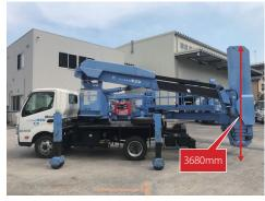
デッキを開きつつブームを旋回させる 解放車線側にデッキが約1.5m程はみ 出すので規制時には注意が必要 デッキ部と車体(アウトリガー)には緩衝 装置が効かないので、接触に注意する
