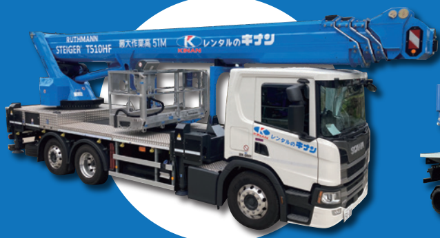
51m 大型高所作業車 T510HF
